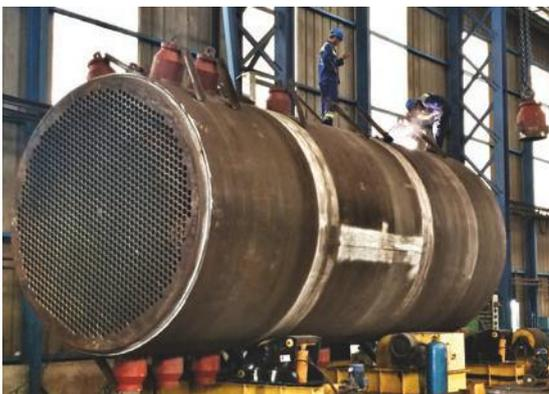
Fabrication d'une chaudière de récupération (1200 tubes)
