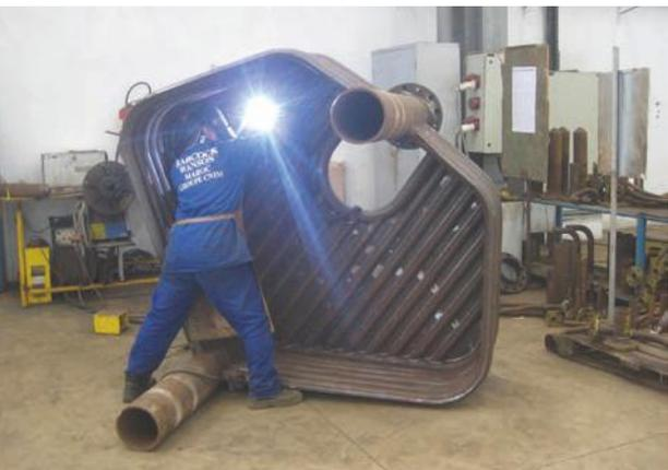
Fabrication d'un écran d'eau pour chaudières à tubes de fumée
