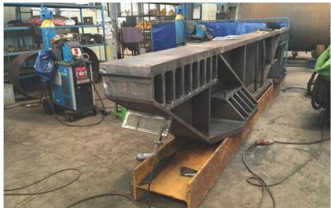
Fabrication d'éléments chaudronnés et mécano-soudés
