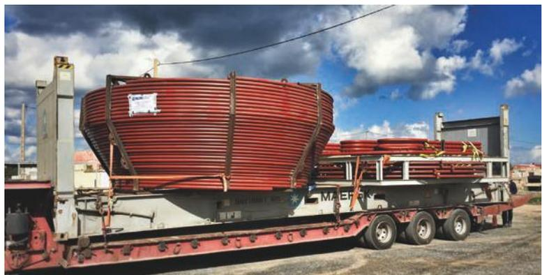
Fabrication d'un surchauffeur évaporateur pour chaudière nitrique
